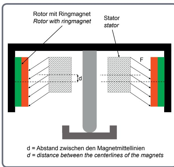
Die **MagFix** Lagerung von **SEPA EUROPE** dagegen besteht aus einem Gleitlager für die radiale Positionierung und einem sogenannten Spurlager für die axiale Fixierung an der Spitze der Rotorwelle. Vereinfacht dargestellt wird durch einen Versatz der Spulen zum Magnet oder durch eine Magnetbahn-platte eine Kraft in axialer Richtung genutzt, um die Fixierung im Spurlager sicher zu stellen. Dadurch bleiben die Lagerschultern frei und ein Abwandern des Öls wird sicher vermieden.
